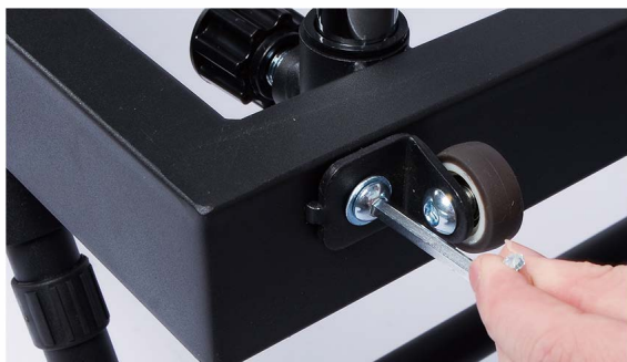
30. Tag pakningen og skru hjulet på og spænd det med unbrakonøgle.
